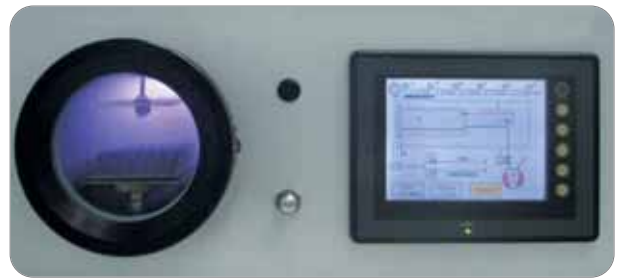
Reattore al plasma in funzione durante un processo di decontaminazione superficiale degli impianti
