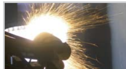
Sistema robotizado semiautomático de revestimiento de un implante dental en HRPS: el implante gira sobre sí mismo durante la operación para permitir un tratamiento homogéneo y constante
